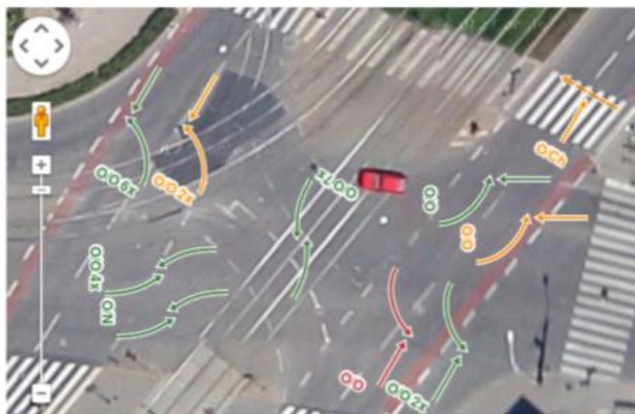
Příklad části konfliktního diagramu na podkladu ortofotomapy
