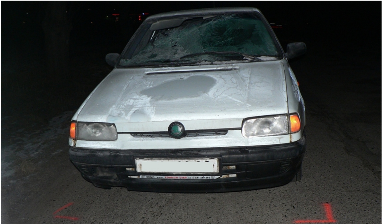
Obr. 2.6 - Zanedbání přípravy vozidla před jízdou (neočistěná námraza na předním skle)
