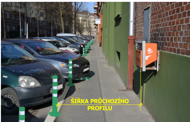
Obrázek 08. Flexibilní regulační sloupek - zelený
