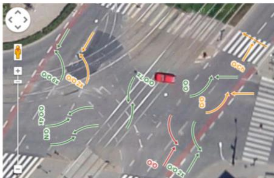
Příklad části konfliktního diagramu na podkladu ortofotomapy
