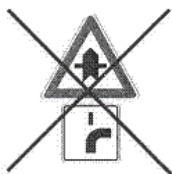
Obr. 17: Psychologicky velmi nebezpečná kombinace dopravních značek
