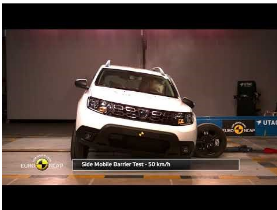
Nárazová zkouška vozidla Dacia Duster
