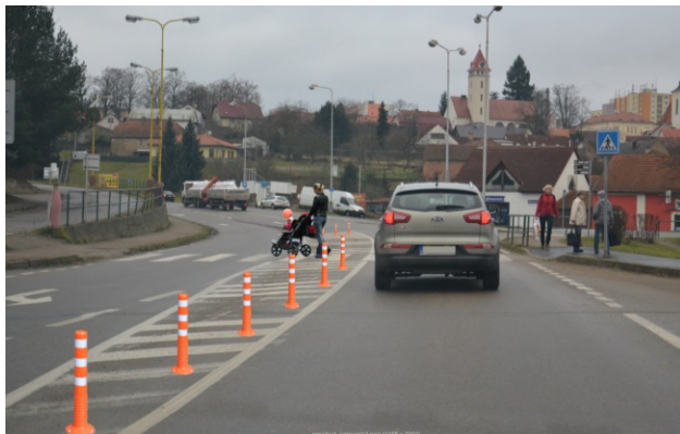
Obrázek 06. Flexibilní regulační sloupky - oranžové
