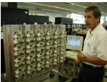
Obr. 6: Testování OBU ve výrobním závodě FELA
