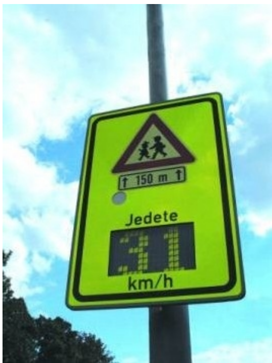
Obr. 1: dopravní zařízení doplňující svislou dopravní značku
