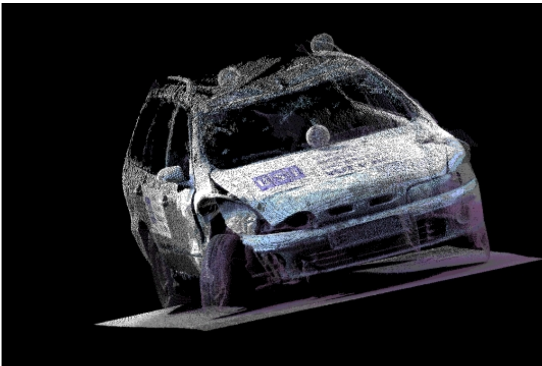
Obr. 3 - Fotografická interpretace 3D modelu havarovaného vozidla
