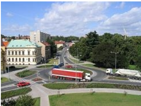
Obr. 23: Styková křižovatka nahrazená okružní (I/37, Chrudim)
