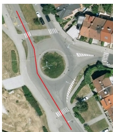
obr. 03. Nevhodně navržená OK - možný přímý průjezd
