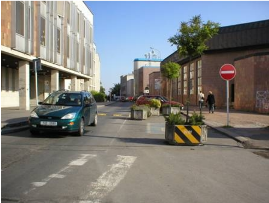
Obr. Pohled na provizorní zúžení s úzkým zpomalovacím prahem
