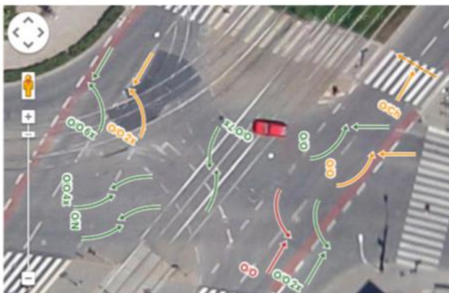
Příklad části konfliktního diagramu na podkladu ortofotomapy
