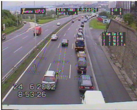
Obr. 5 Schéma a základní reálný videoobraz sledovaného odbočování
