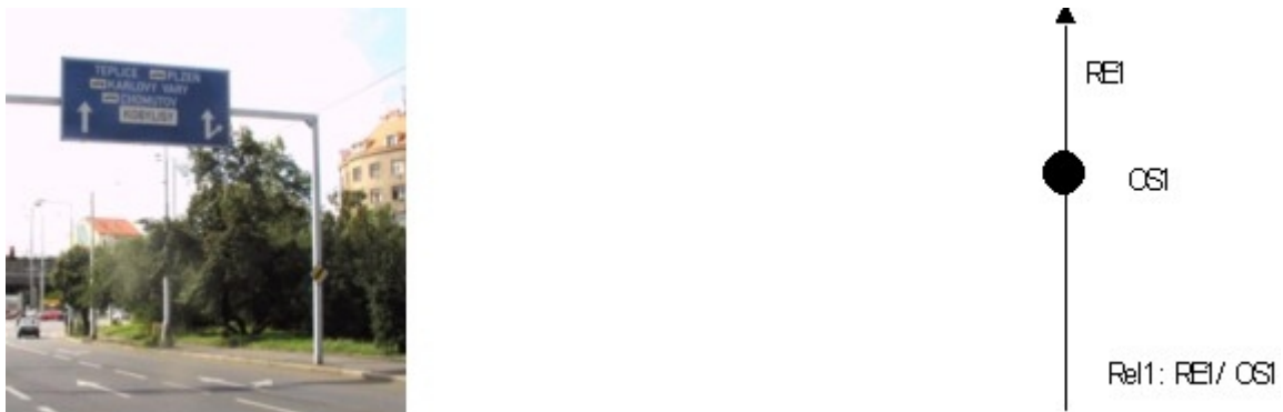
Obr. 4: Příklad reálného umístění dopravních informačních tabulí a odpovídající reprezentace v databázi, Praha 9
