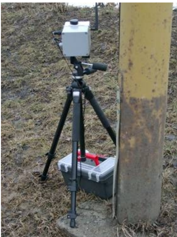
Obrázek 4 - Radar umístěný za sloupem veřejného osvětlení
