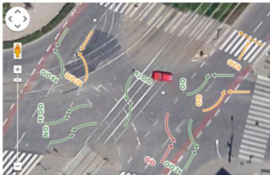
Příklad části konfliktního diagramu na podkladu ortofotomapy
