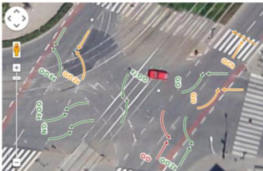
Příklad části konfliktního diagramu na podkladu ortofotomapy
