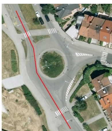
obr. 03. Nevhodně navržená OK - možný přímý průjezd
