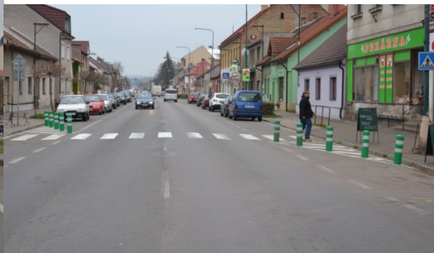
Obrázek 07. Směrové sloupky zelené kulaté - baliseta
