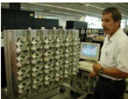
Obr. 6: Testování OBU ve výrobním závodě FELA
