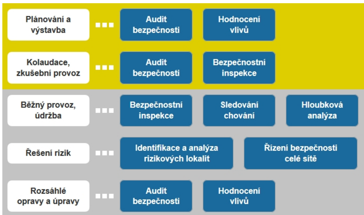
Obr. 2 - Přehled nástrojů pro zvyšování bezpečnosti dle fází životního cyklu pozemních komunikací
