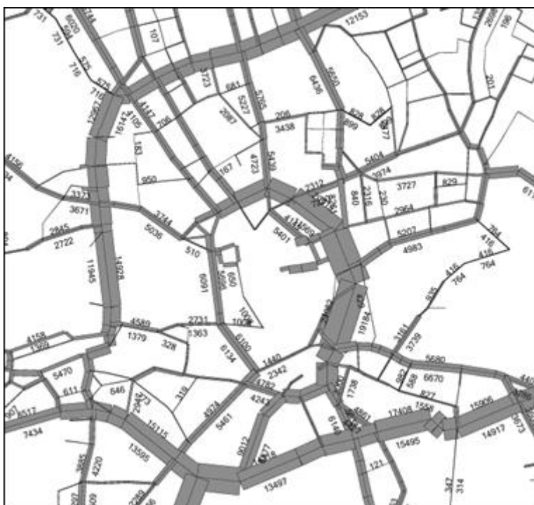
Obrázek 1 Výsledky modelování dopravních objemů v centru Brna.
