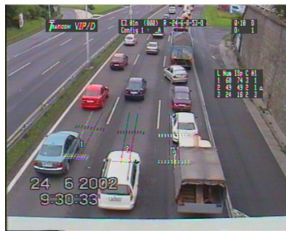
Obr. 5 Schéma a základní reálný videoobraz sledovaného odbočování
